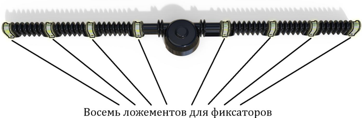
Рис. 10. Расположение ложементов на кожухах устройства
