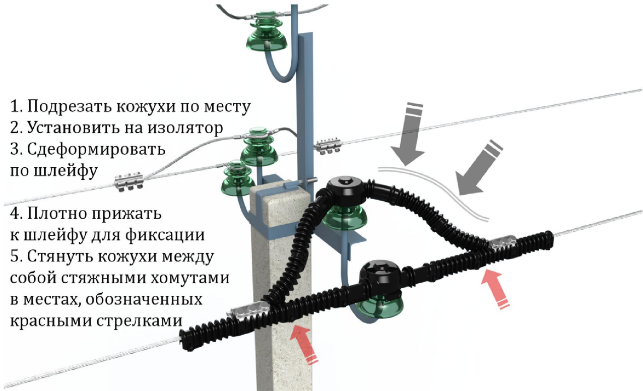
а) установка ПЗУ-6-10кВ-line
